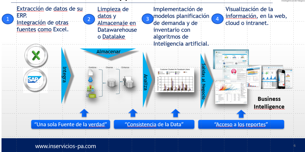
Figura 3. Proceso de ETL e implementación de algoritmos de Inteligencia artificial de planificación de demanda y de inventario.
